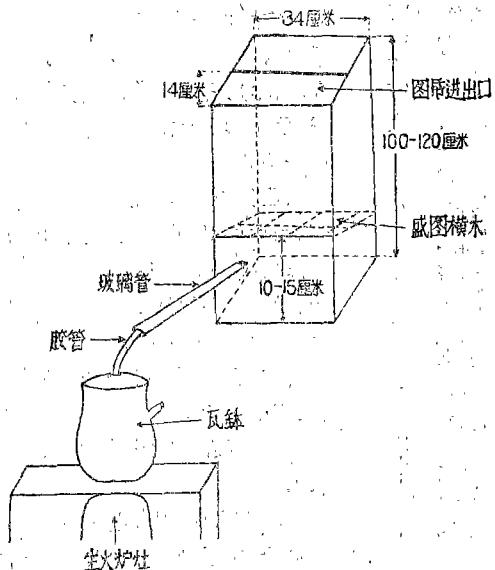
注：放图纸后要馬上用黑布盖住进出口，以免露光而影响图的质量。
