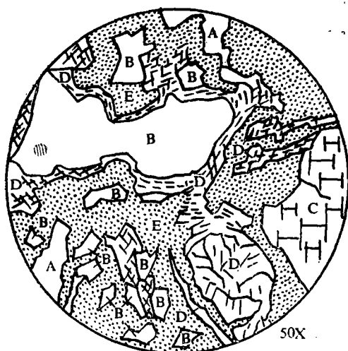
图1 砂姜的物质组成及其存在状态。其中方解石以两种主要形式存在：一种是较大的方解石晶块，另一种是附着于他物体的晶膜。
