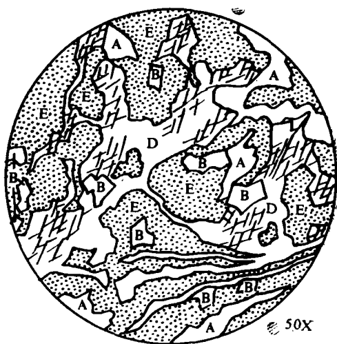
图6 示砂姜中方解石晶膜的厚度变化很大，并常可见有各种形态的分支。说明晶膜的厚度和形状决定于土壤孔隙的形态。
