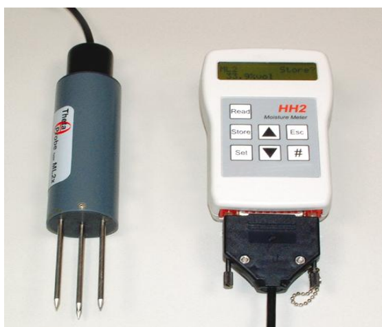
图 9 Theta Probe 便携式 TDR
