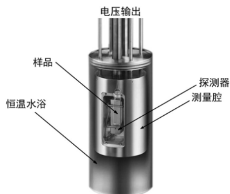
图1 微量热仪(TAM III 微热仪(TA Instrument, USA))原理图 [6]
