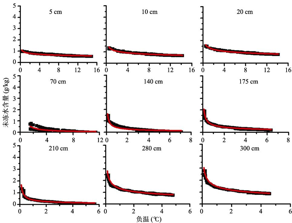
图6 未冻水含量随温度变化的拟合曲线
