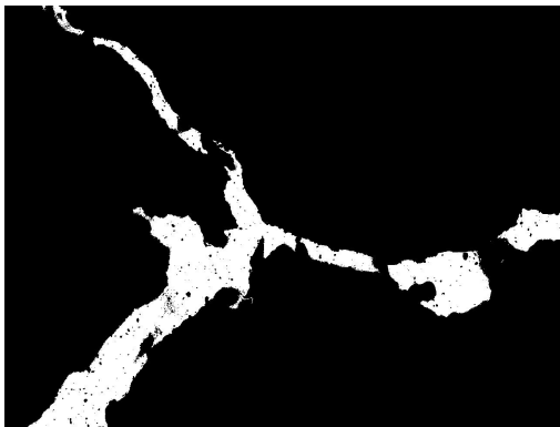
图 20 剖面 MY2 Bt 层土壤孔隙二值图(×50) Fig. 20 Pore image of Bt horizon of MY2(×50)
