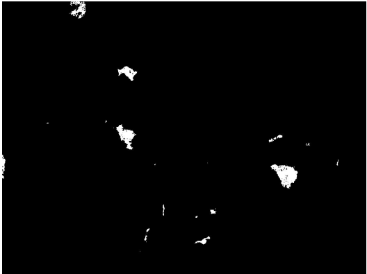
图 22 剖面 MTG13AB 层孔隙二值图(×50) Fig. 22 Pore image of AB horizon of MTG13(×50)
