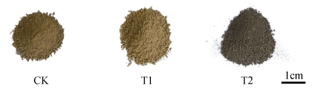
(CK: 背景土壤, 未添加柴油; T1: 柴油污染土壤; T2: 柴油污染土壤在 250 ℃ 加热 10 min)
