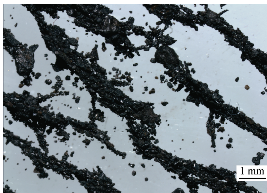
图 1 重液分离出的载磁矿物在磁场作用下定向排列
