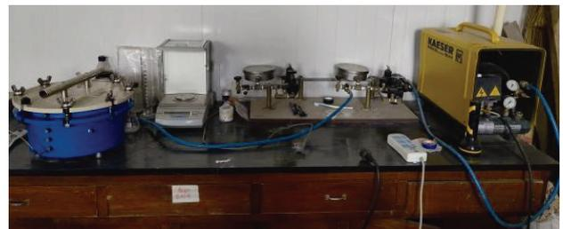
图 1 压力膜仪
