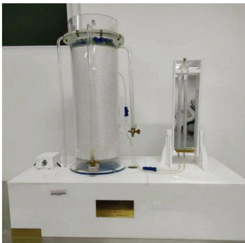
图 2 试验所用土柱装置
