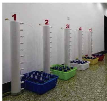
图 1 室内砂柱试验装置示意图 Fig. 1 Indoor sand column test device diagram
