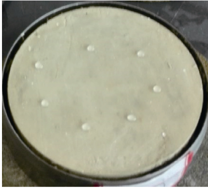
图 2 P0.4 试样的 WDPT 测量试验 Fig. 2 Test of WDPT at P0.4
