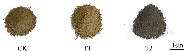
(CK: 背景土壤, 未添加柴油; T1: 柴油污染土壤; T2: 柴油污染土壤在 250 °C 加热 10 min)
